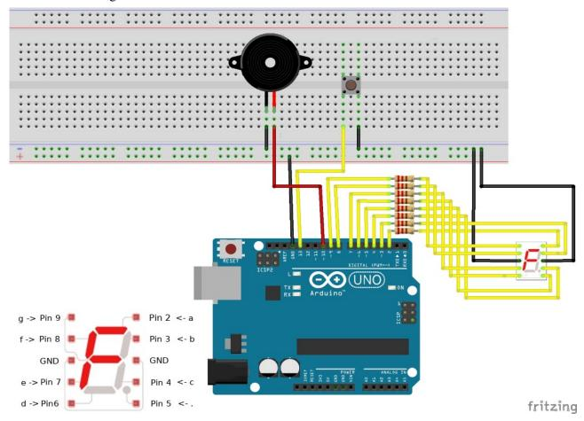
Die Zahlen, die dargestellt werden sollen, werden als Binärwert notiert. Eine 1 steht für Segment einschalten, eine 0 zeigt das Segment nicht an. Die Reihenfolge der Ziffern entspricht der Reihenfolge der Pins. Die erste Ziffer schaltet Pin 2, die zweite Pin 3 und die letzte Pin 9.
