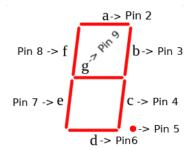
Die Segmente sind von a bis g gekennzeichnet. Jedes Segment muss mit einem Pin des Arduinos verbunden werden.
