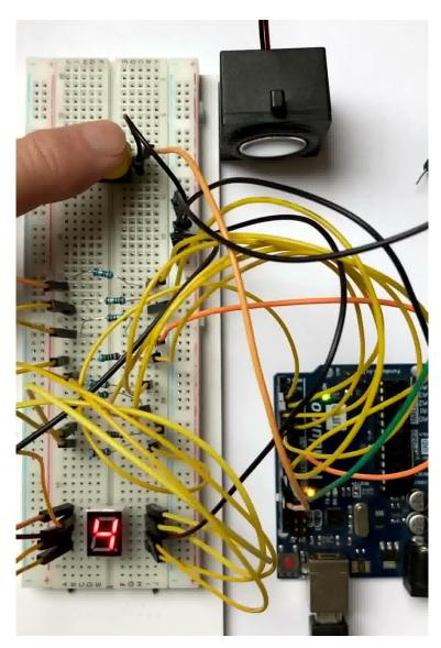
Das Programm würfelt eine Zahl und zeigt sie auf dem 7-Segment-Display an. Kurz angezeigte Zufallszahlen simulieren den Würfelvorgang, bevor die endgültig gewürfelte Zahl angezeigt wird.
